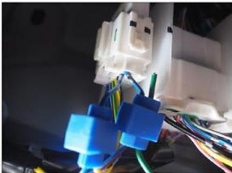
Connectez le kit de centralisation au faisceau de la fermeture centralisée du véhicule.
