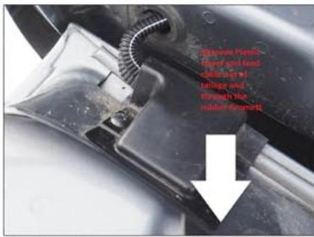
Faites sortir le faisceau par le hayon côté passager. Utilisez la gaine pour protéger le câble.
