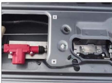
Installez la plaque et le moteur de centralisation et maintenez-les en remettant les vis retirés dans l'étape précédente.
