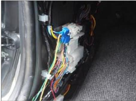
Retirer le seuil de porte côté passager ainsi que le panneau de protection pour accéder au faisceau électrique du véhicule.
