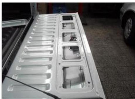
Ouvrez le hayon de la benne, dévissez les 10 vis et ôtez le panneau intérieur en métal pour accéder à l'intérieur du hayon.
